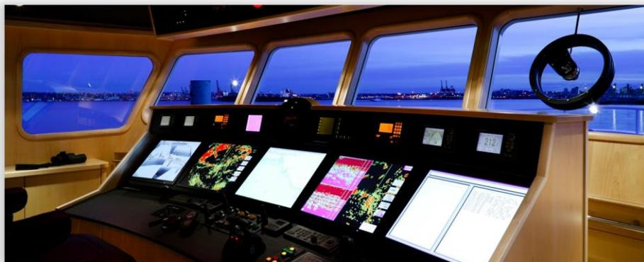
“日本一家研发、生产海军舰艇系统的全球领先公司要求SECO为海军舰艇中央控制系统开发一套定制软硬件系统集成解决方案，该方案可以提供带有GPS的精确航海图，并连接声纳、雷达和激光传感器等其他设备
