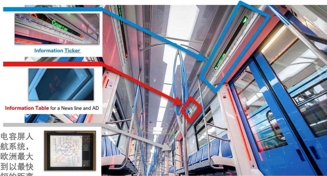
带有触摸式电容屏人机交互导航系统，帮助乘客在欧洲最大的地铁中找到以最快的方式及最短的距离到达乘客目的地
